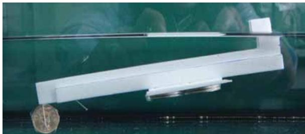
圖(23c)為「艦部過沉，艉部過仰」之俯仰姿態。從水槽底部放開水下滑翔機模型時，雖仍會浮出水面，但是會朝艉部後退
