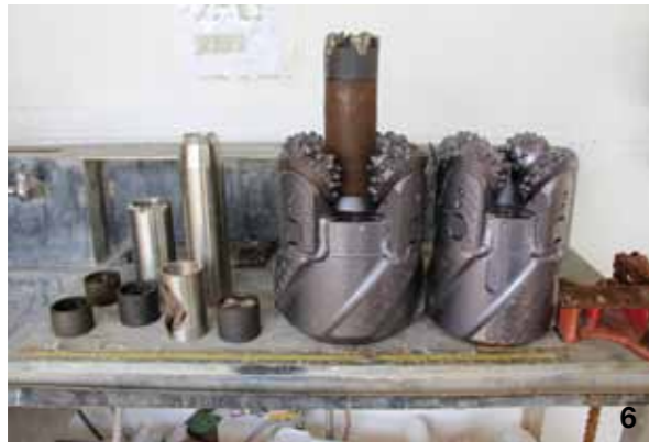
4 動力定位系統的其中一個側推器。 5 岩心薄片室。 6 透過特殊鑽頭，採集深海地層樣本。 7 微生物實驗室。
