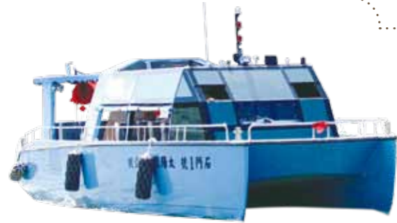
石門水庫太陽能電動公艇，為採用太陽能之環保電動船，以達到節能減碳之目標並減少環境汙染。船長14公尺，船寬4.5公尺，吃水深0.6公尺，船身採雙胴體設計，搭載成員額40人，最高速度10節。
