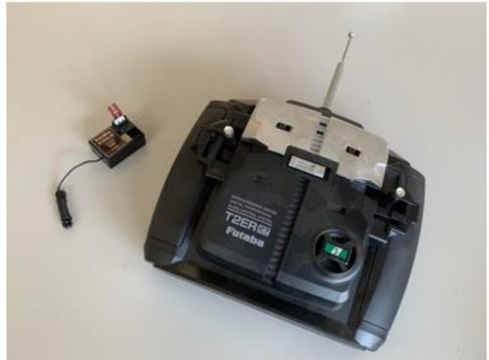
市售 3 通道 27MHz 板型遙控收發器
