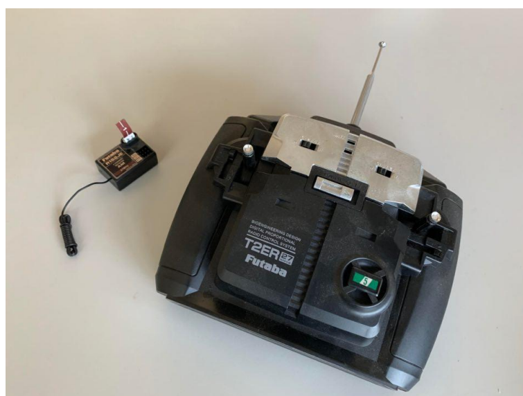
市售 3 通道 27MHz 板型遙控收發器
