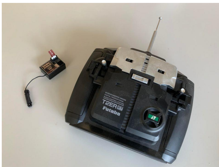
市售 3 通道 27MHz 板型遙控收發器
